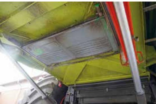
Die Auffangschale wird samt Ablegemechanismus unter dem Schrägförderer montiert.
