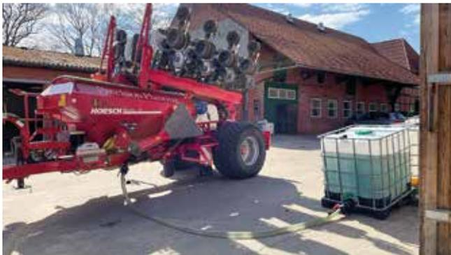
Das Horsch/Precision Planting-Gerät wird zur flüssigen Saatbanddüngung mit einem Mischdünger aus APP und KTS betankt.
