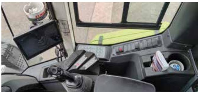
Bedient wird der Torion über einen Joystick und ein Terminal.
