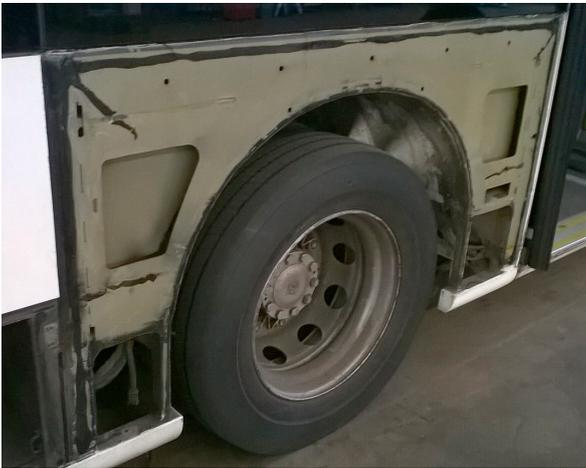
Nach dem Austrennen und Entfernen der beschädigten Seitenwand wird die Klebefläche an der Karosserie wie folgt vorbereitet:
