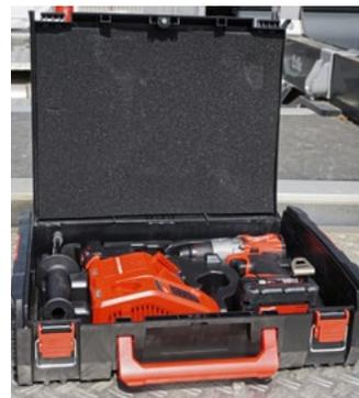
Das vom Werkstatt-ausrüster Winkler in den Test geschickte Modell von Milwaukee ist als Schlagbohrschrauber ein Kombiwerkzeug. Geliefert wird das Gerät in einem stabilen Transportkoffer, der sich abschließen lässt, was unser Tester als positiv vermerkt. Zum Lieferumfang gehören ein Schnellladegerät und zwei Lithium-Ionen-Akkus mit einer Kapazität von 5 Ah. Eine Ladestandsanzeige ist vorhanden. „Es empfiehlt sich, vor dem Ar-
